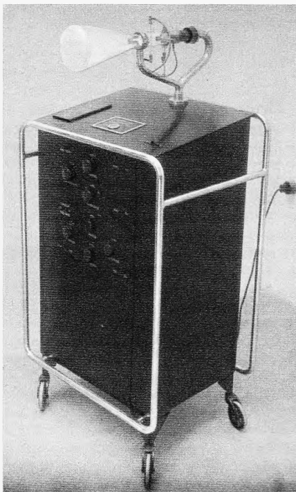
Elektronenstrahl-Oszillograf aus dem Jahre 1932, entwickelt von M. v. Ardenne, gebaut von Dipol AG, Arbon, Schweiz. In dem Gehäuse befinden sich Netzteil und Kippperät (Foto: Manfred von Ardenne)
